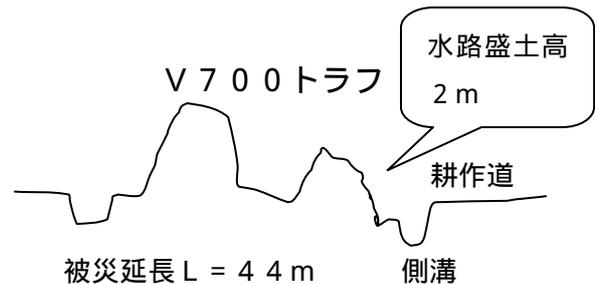
豪雨により用水路盛土部の法尻が流出、法面が崩壊し用水路が被災した。
