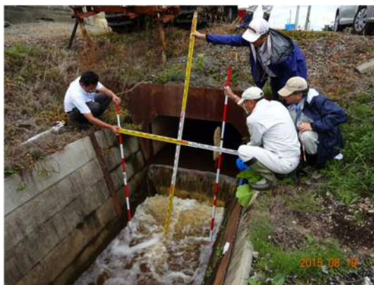
柵渠断面 上幅 2.2m 下幅 1.2m 高 1.6m
