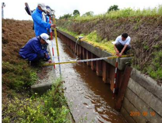
鋼矢板断面 幅 2.05m
