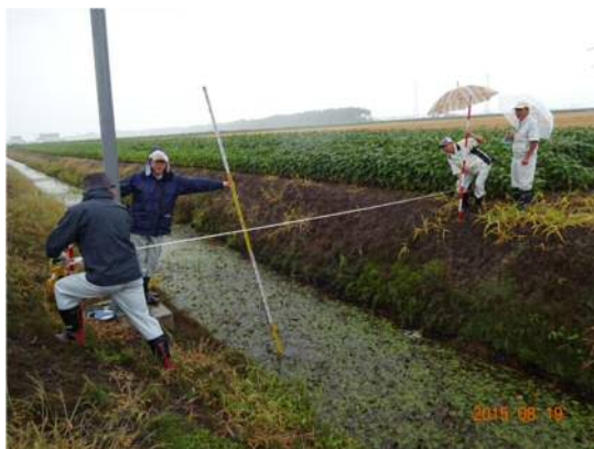
土水路断面 上幅 6.0m、水深 0.6m
