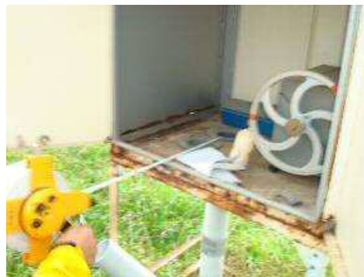
ロープ式水位計による測定
