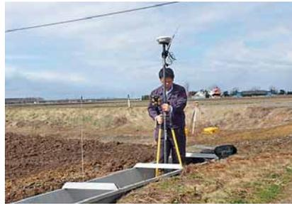
RTK-GPSを使用した細部測量
