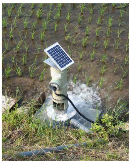
写真7 左 自動給水栓設置例 右 自動排水栓設置例
